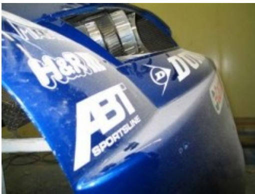
vor dem chemisch Entlacken
